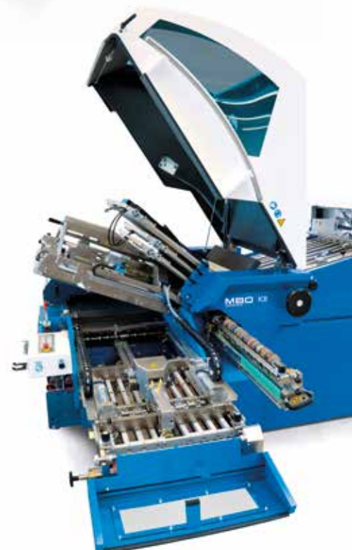
K8 mit herausgezogener Messerwellenkassette und geöffnetem Schwertfalzbereich.
