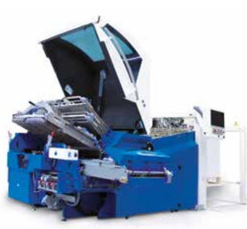
Automatisierte K8RS mit geschlossenem (links) und geöffnetem (rechts) Schwertfalzbereich.
