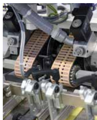
Certaines des fonctionnalités de la K8RS en version standard, de gauche à droite : Margeur à palettes, tête séparatrice Vaculift RS, double Vacubelt et entraînement à courroie dentée dans le pli parallèle.
