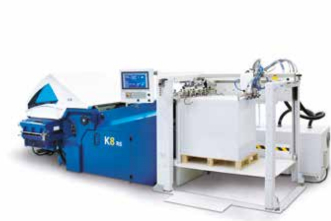
K8RS automatisée avec zone de pliage à couteau fermée (à gauche) et ouverte (à droite).
