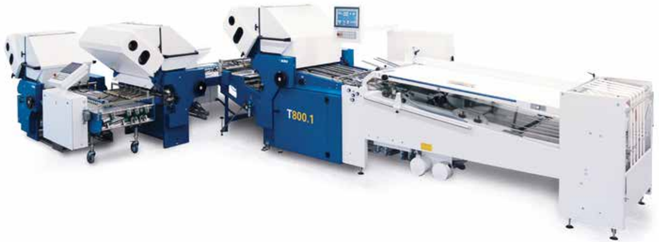
Automatisierte T800.1 mit Rundstapelanleger und Falzwerk II und III.
