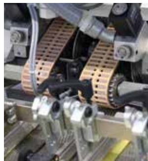
Einige der standardmäßigen Features der K8RS, von links nach rechts: Palettenanleger, Trennkopf Vacujet RS, Doppel-Vacubelt und Zahnriemenantrieb im Parallelbruch.
