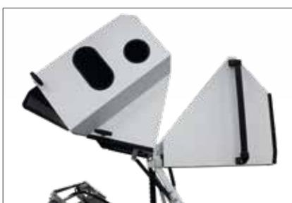
Die zweiteilige Lärmdämmeinrichtung ist ein Standard-Feature in allen Falzwerken – sowohl in der T800.1 als auch in der B30. Sie sorgt nicht nur für einen optimalen Lärmschutz, sondern auch für eine gute Zugänglichkeit zu den Falztaschen und -walzen.
