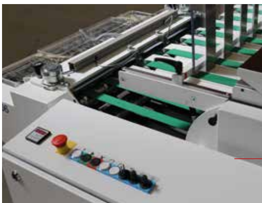
Armoire électrique avec pupitre de commande intégré.
