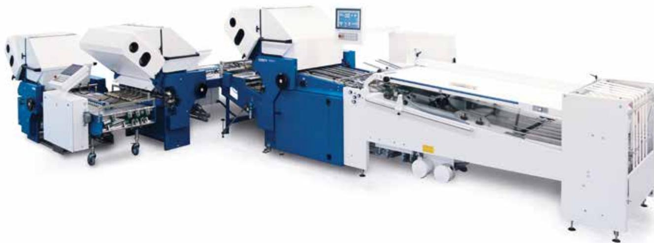
T800.1 automatisée avec margeur rotary, groupe de pliage II et III et dispositif de retour de feuille RFE dans le groupe de pliage III.
