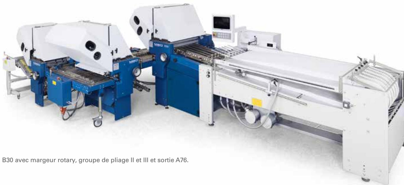
B30 avec margeur rotary, groupe de pliage II et III et sortie A76.
