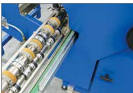
**Cassette MKW à arbres porte-outils pour arbres porte-outils post-positionnés (1 paire simple)** Équipement standard dans le groupe de pliage I, équipement supplémentaire dans le groupe de pliage II
